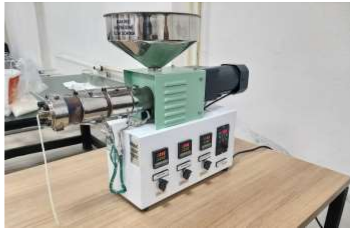
Şekil 1. SJ35 model laboratuvar tipi masaüstü mini tek vidalı ekstruder
