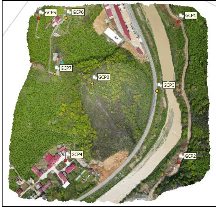
Şekil 6. YKN'lerin araştırma sahasındaki dağılımı (kırmızı noktalar: doğruluk değerlendirmesi için ayrılan kontrol noktalar, sarı noktalar: referanslama noktaları)
