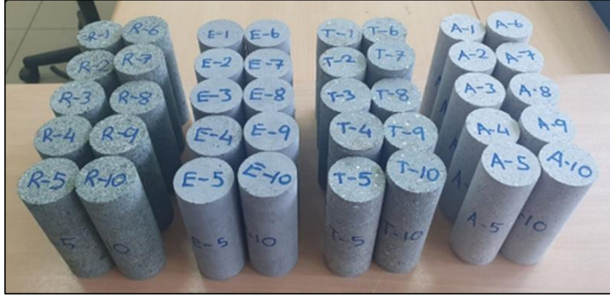
Şekil 2: Deneyler için hazırlanmış silindirik numuneler
