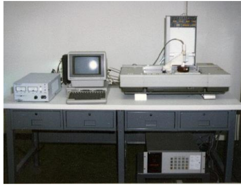
Görsel 5. Charles Hull tarafından yapılan SLA-1 isimli ilk üç boyutlu yazıcı.
