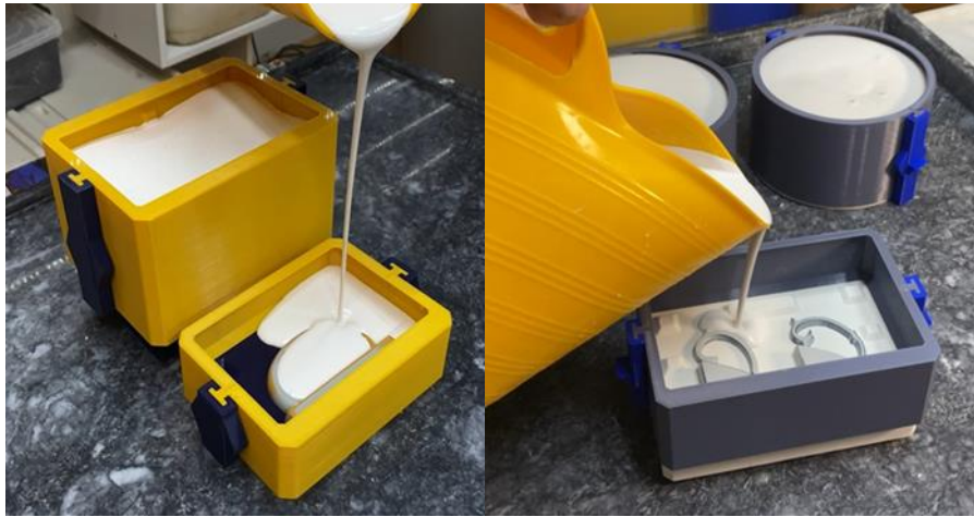
Görsel 9. 3D yazıcı ile oluşturulan model, teksir kalıp parçası ve kalıp çerçevesi.
