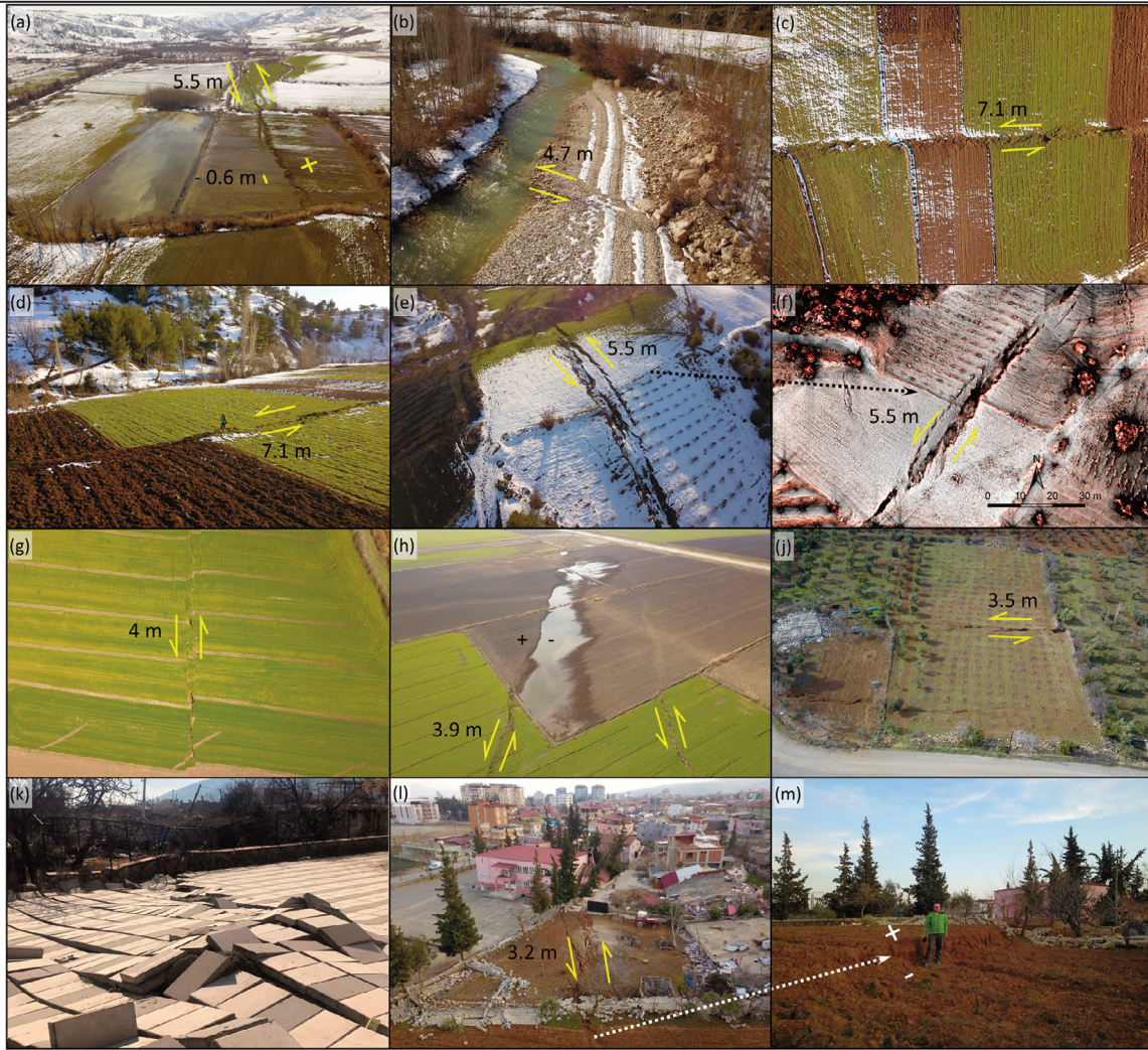
Fotoğraf 2. DAF'ın Pazarcık ve Amanos segmentlerindeki yüzey kırıkları. (a) Pazarcık Göynük Mh. güneyi; (b) Pazarcık Sakarkaya Mahallesi yakınlarında Aksu Çayı yatağındaki ötelenme; (c ve d) İlk depremin merkez üssüne yakın olan ve en yüksek yanıl ötelenmenin ölçüldüğü yer olan Kocadere Mahallesi yakınları; (e ve f) en yüksek ötelenmenin ölçüldüğü lokasyonun yakınındaki bir sırtta meydana gelen yırtılma; (g) Pazarcık Segmenti'nin Kahramanmaraş şehrinin güneyindeki bölümü; (h) Pazarcık Segmenti'nin Türkoğlu ilçesi doğusunda yüzey kırığı boyunca tektonik çöküntü ve göllenme; (j) Nurdağı'nın kuzeyinde Yeşilyurt Mahallesi yakınlarında Amanos Segmenti'nin yüzey kırığı; (k) Türkoğlu Şekeroba Mahallesi içindeki bir parkta Amanos Segmenti'nin yüzey kırığı; (l) Hassa İlçesi'nde Atatürk İlkokulu yakınlarında Amanos Segmentinde 3.2 m yanıl ötelenme ve (m) fayın düşey bileşeni.
