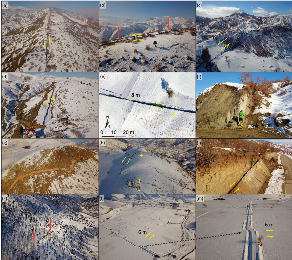
Fotoğraf 1. (a, b, c, d, e, f, g, h ve j) Çardak Fayı'ndaki, (k) Sürgü Fayı'ndaki ve (l ve m) Erkenek Segmenti üzerindeki yüzey kırıklarının İHA görüntüleri. (a, b ve c) Çardak Fayı'nın Uzunsırt üzerindeki yüzey kırığı; (d ve e) Çardak Fayı'nın Ekinözü Aşağııçmeler Mahallesi batısında ikinci depremin merkez üssünde ölçülen maksimum yer değiştirme ve yamaç eğimi nedeniyle oluşan büyük eğim kırıklığı; (f ve j) Çardak Fayı'nın uzunsırt batısında Gözükaralarobası Mahallesi yakınlarında yüzey kırığı; (g) Ekinözü Aşağııçmeler Kırkgöz Pınarı mevkiinde gerilmeye bağlı olarak oluşan yarık ve 10 metreyi bulan oturma, potansiyel heyelan alanı; (h) Ekinözü güneydoğusunda Gözpinar yakınlarında tektonik çöküntüler görüldüğü Kurtgediği Tepeleri mevki; (k) Sürgü Çayı Vadisi'nde Küçüklü Mh. yakınlarında Sürgü Fayı'nın doğudaki son yüzey kırığı; (l ve m) DAF'ın Erkenek Segmenti'nde 6 metrelik yanal ötelenme, Çelikhan güneydoğusunda Merk Düzü; fotoğrafın (e) sağ üst köşesinde görülen sulak alan, fayın dere yatağını kesmesi nedeniyle krevas oluşumu ve taşkını göstermektedir.
