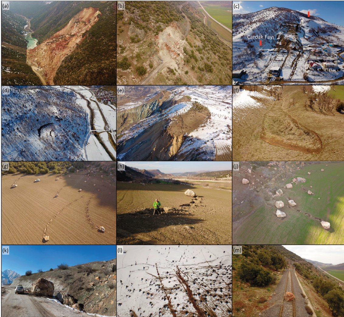
Fotoğraf 3. Deprem anında meydana gelen kütle hareketlerine örnekler. (a) İslahiye Değirmencik heyalanı ve set gölü; (b) İslahiye kuzeyi; (c) Ekinözü güneybatısında Çardak Fayı'nın yüzey kırığı üzerinde meydana gelen ve bazı evlerde hasara neden olan heyelan; (d) Sürgü Fayı'nın kısa bir bölümünde oluşan yüzey kırığı üzerinde oluşan heyelan; (e) Erkenek Segmenti'nin Göksu Vadisi'nin güney yamaçlarını kesmesi sonucu oluşan yarıklar; (f) Pazarcık kuzeyinde Pazarcık Segmenti'nin 200 m yakınında oluşan sığ toprak akması; (g, h, j) Pazarcık kuzeyinde kaya düşmeleri; (k) Çağlayancerit güneyinde kaya düşmeleri; (l) Nurhak doğusunda ve (m) İslahiye kuzeyinde kaya düşmeleri.
