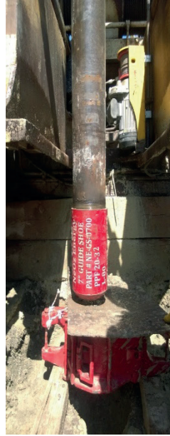
Şekil 4: Yüzdürme Kılavuzu ve Yüzdürme Yakası ekipmanlarının kuyuya indirilen ilk boruya eklenmesi
