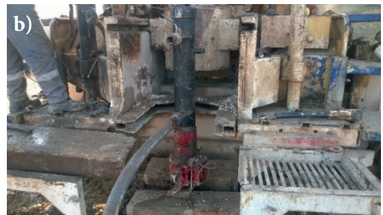
Şekil 6: a) Alt ve üst tapa, b) Çimentolama başlığı Figure 6: a) Lower and upper plug, b) Cementing head
