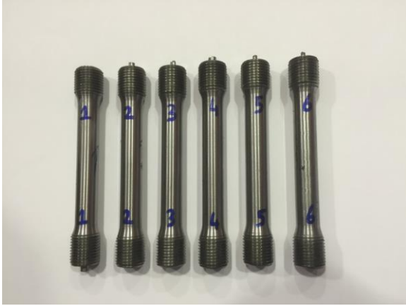
Şekil-3) Çekme testi yapılan numunelere ait görüntü
