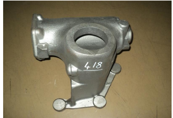
Şekil-2) Ticari araç hidrolik direksiyon gövdesi
