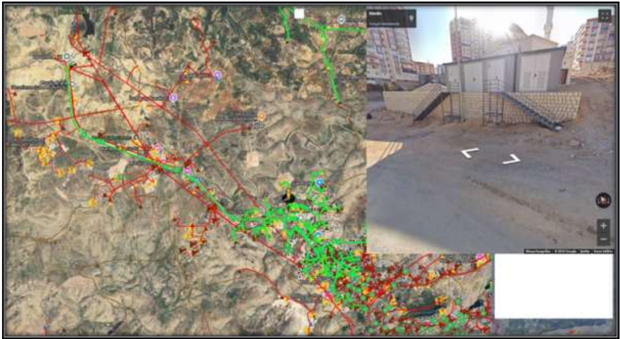
Şekil 6. Fider bazlı olarak hatların enerjilendirilmesi ve panoramik görüntü ile hat güzergâhlarının görüntülenmesi
