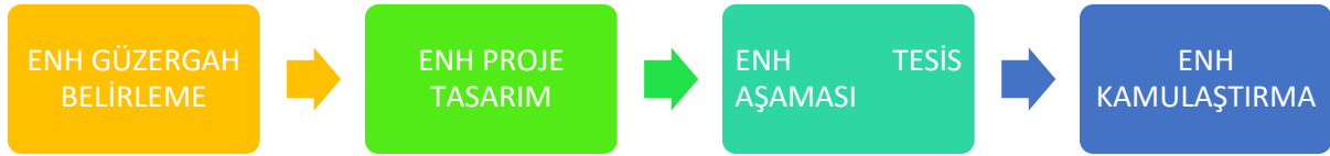
Şekil 1. Enerji nakil hatları yapım aşamaları ve süreçleri
