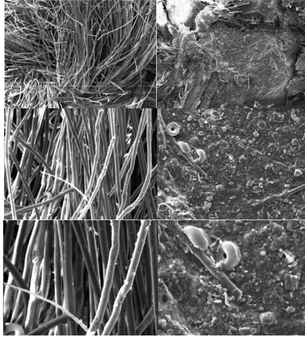
Şekil 7. IFAS B için çalışma öncesi(sol) ve sonrası(sağ) sırasıyla 100, 500 ve 1000 kat büyütülmüş SEM görüntüleri
