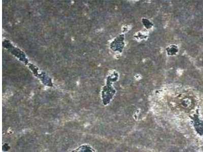
Şekil 9. Kireç çamurtaşı. Erime boşluklu (siyah lekeli alanlar) olup boşluklar kısmen kalsitle doldurulmuştur. Kaya gözenekli yapı gösterir (Büyütme: 10x).
