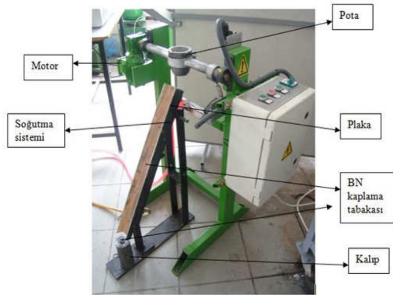
Şekil 1. Çalışmada kullanılan eğimli soğutma plaka düzeneği.
