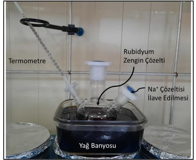
Şekil 1. Lityum çöktürme deney düzeneği
