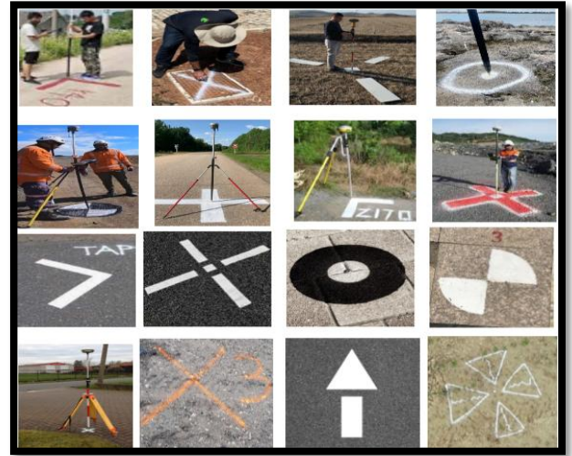
Şekil 2.3, Arazide boya ile elde edilmiş YKN şekilleri
