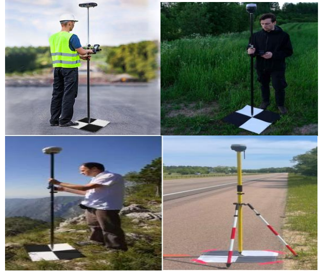
Şekil 2.1, YKN'larının Jeodezik Ölçümü
