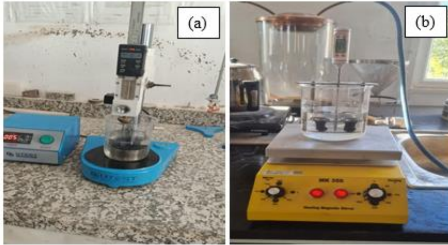
Şekil 2. Penetrasyon (a) ve yumuşama noktası (b) cihazları. Figure 2. Penetration (a) and softening point (b) devices.
