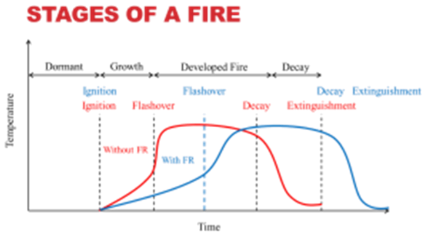
Şekil 2: Yangın Zaman – Sıcaklık Grafiği (1)
