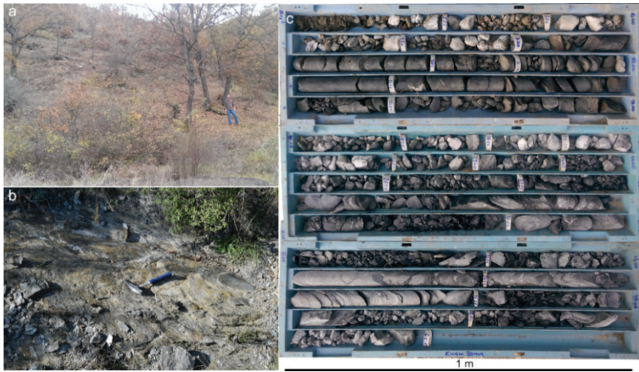
Şekil 3. T34-GT2 tünel girişinde bulunan meta-kırıntılılar (a), meta-kırıntılıların mostradaki görünümü (b) ve Sk-1 sondaj kuyusuna ait karot sandık fotoğrafı (c).
