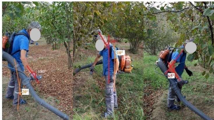
Şekil 13. Üfleme makinesi operatörünün duruş pozisyonları
