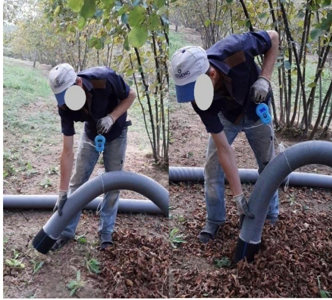
Şekil 3. Emiş hortumu boş ve dolu ağırlık ölçümü
