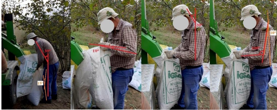
Şekil 16. Fındık paketleme ünitesi operatörünün vücut açıları
