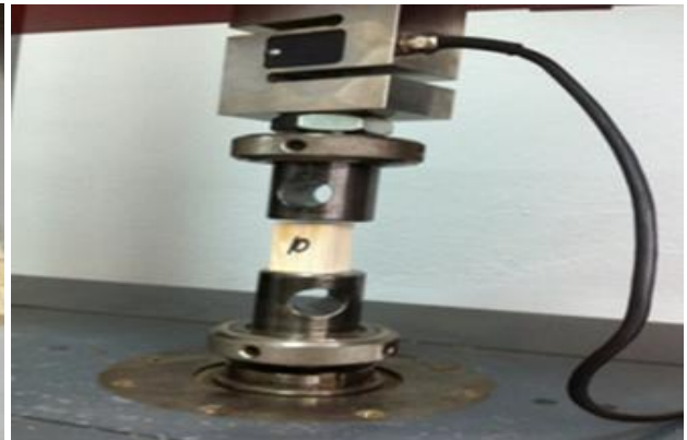
Şekil 2. Liflere paralel basınç direnci testi Figure 2. Compressive strength test parallel to the fibers
