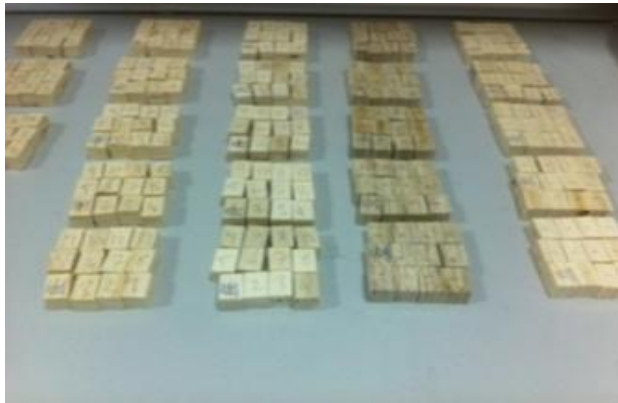
Şekil 2. Liflere paralel basınç direnci testi Figure 2. Compressive strength test parallel to the fibers
