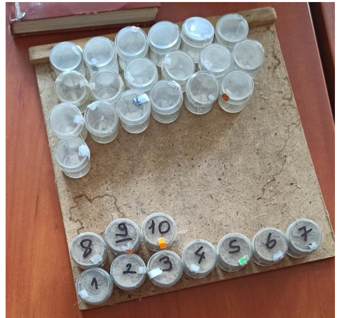
Şekil 6. Serbest numunelerin toz haline getirildikten sonra ölçüm için hazırlanma evresi
