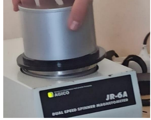
Şekil 7. Spinner manyetometresinde mıknatıslanma şiddeti ölçüm aşamaları
