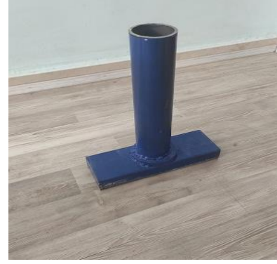
Şekil 4. Deneylerde kullanılan model şerit temelin görünümü
