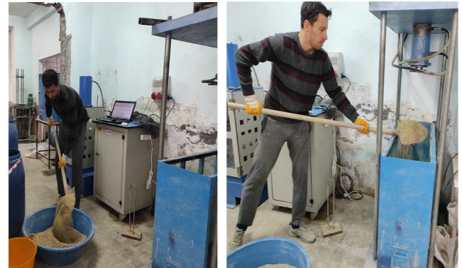
Şekil 5. Kum zeminin karıştırılması ve tank içerisine aktarılması
