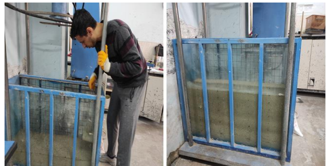
Şekil 6. Kum zeminin sıkıştırılmış hali
