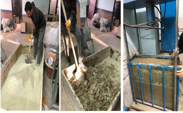
Şekil 7. Kil zeminin optimum su muhtevasına getirildikten sonra sıkıştırılması
