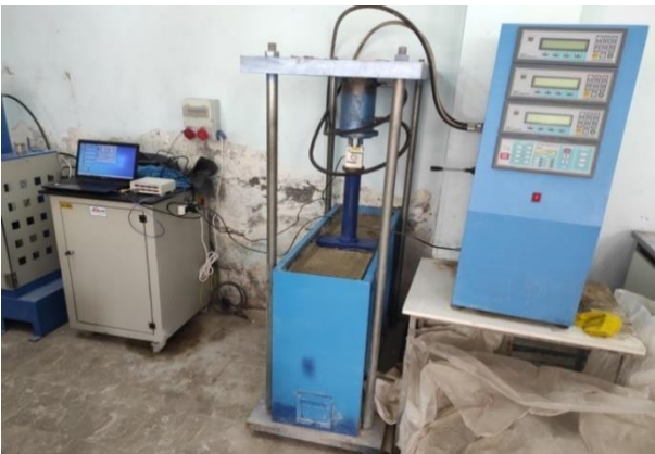
Şekil 8. Katkısız zemin üzerine yerleştirilen temelin yüklenmesi
