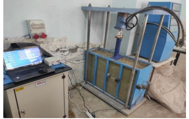
Şekil 9. Tankın yanal yüzeylerindeki deformasyonların ölçülmesi
