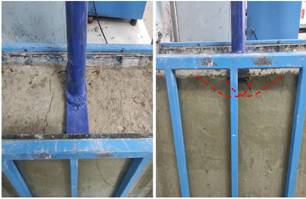
Şekil 13. BF+SD katkılı zeminin yükleme sonrası görünümü
