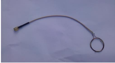
Şekil 8. RF rezonans işaretleyicinin rezonans frekansını network analizör cihazında ölçmek için üretilen kontaklız inceleme probu
