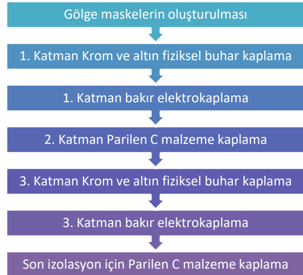
Şekil 1. RF rezonans işaretleyici üretimi akış şeması
