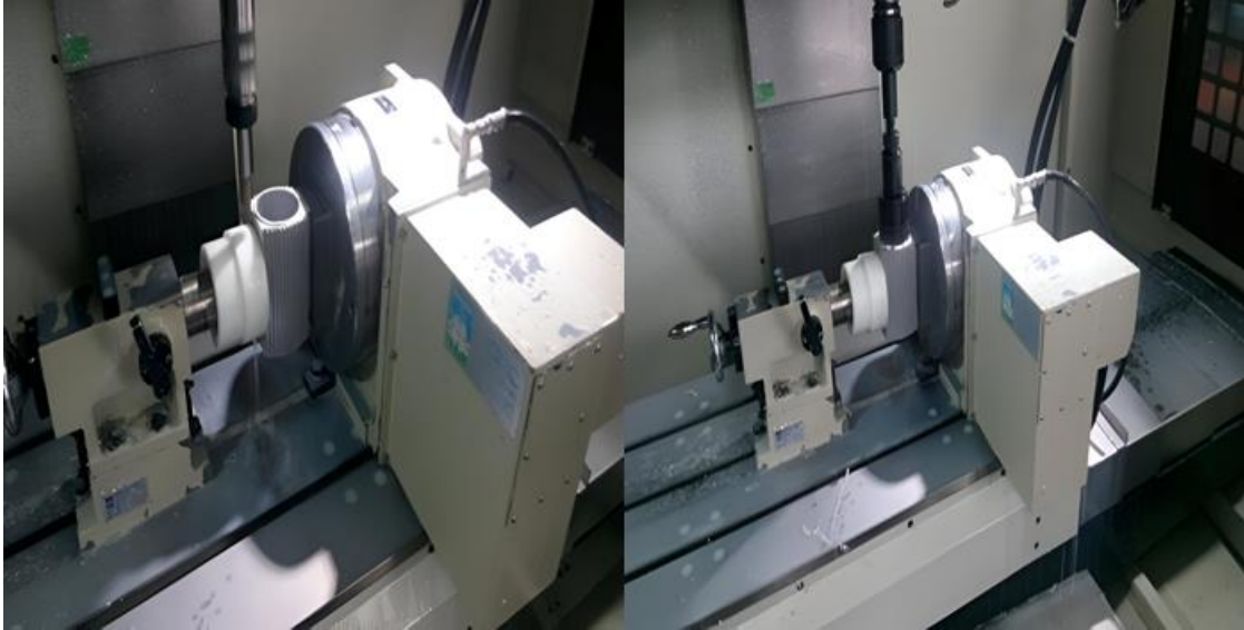
Şekil 2. CNC Tezgâhında işlem gören alüminyum motor gövdesi.
