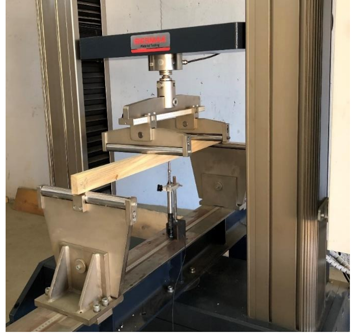
Şekil 2. TS EN 408 (2014) standardına göre 4-noktalı eğilme test düzeneği
