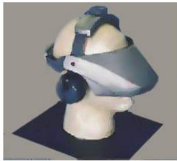
Şekil 3: Kafaya Monte Video Görüş AR Sistemi ve Çizimi (URL3)
