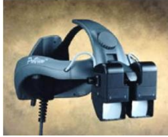
Şekil 1: Kafaya Monte Optik Görüş AR Sistemi ve Çizimi (URL1)
