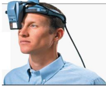
Şekil 2: Kafaya Monte Optik Görüş AR Sistemi ve Çizimi (URL2)
