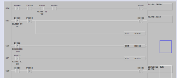
Şekil 12. Operatör paneli üzerinden okunan cihaz arıza ve işlem bitti uyarıları Figure 12. Device malfunction and operation completed warnings read on the operator panel
