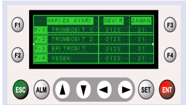
Şekil 18. Operatör paneli fonksiyon tuşlarıyla hafıza özelliği katılmış çalışma sayfası Figure 18. Worksheet with memory feature and operator panel function keys
