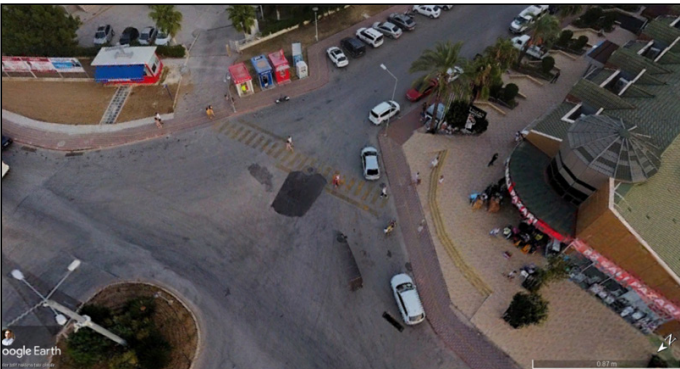
Resim 5. Dr. Derviş Eroğlu Dörtüyl Bulvarı caddesinde kaldırımların göbekte orantısız birleşimi havadan görüntüsü (Google Earth görüntüsü).
