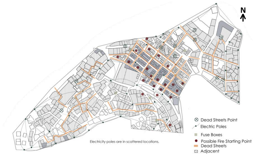
Şekil 21. Yangın risklerinin belirlenmesi
