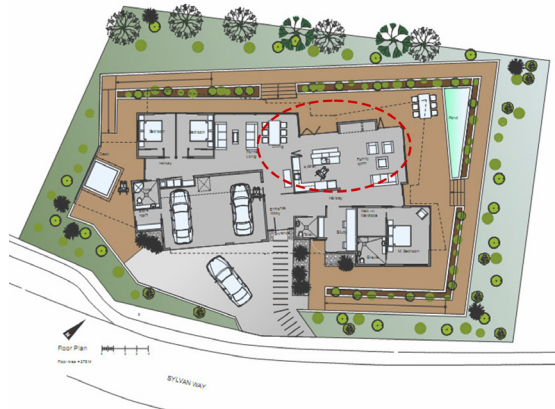
Görsel 10. Blundell Evi’ne ait hareketli separatörleri gösteren zemin kat planı
