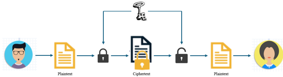
Figure 1. Symmetric Encryption and Decryption (Simetrik Şifreleme ve Şifre Çözme)
