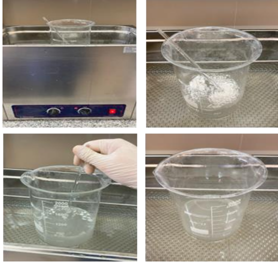
Şekil 2. NFS'nin ultrasonik banyoda su içerisinde dağıtılması
