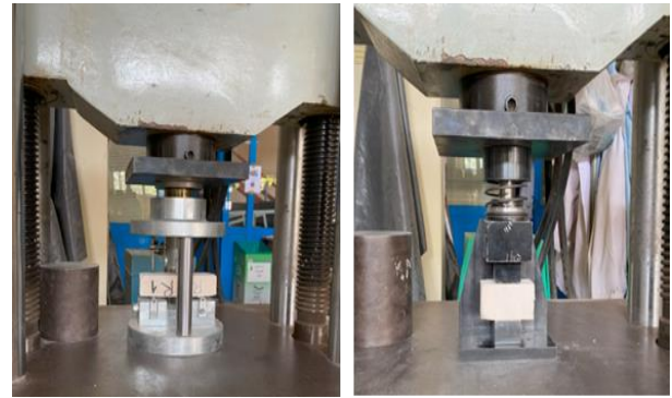
Şekil 3. Eğilme ve basınç dayanım deneyi
