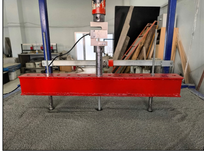
(b) Kiriş ve hidrolik sistem
