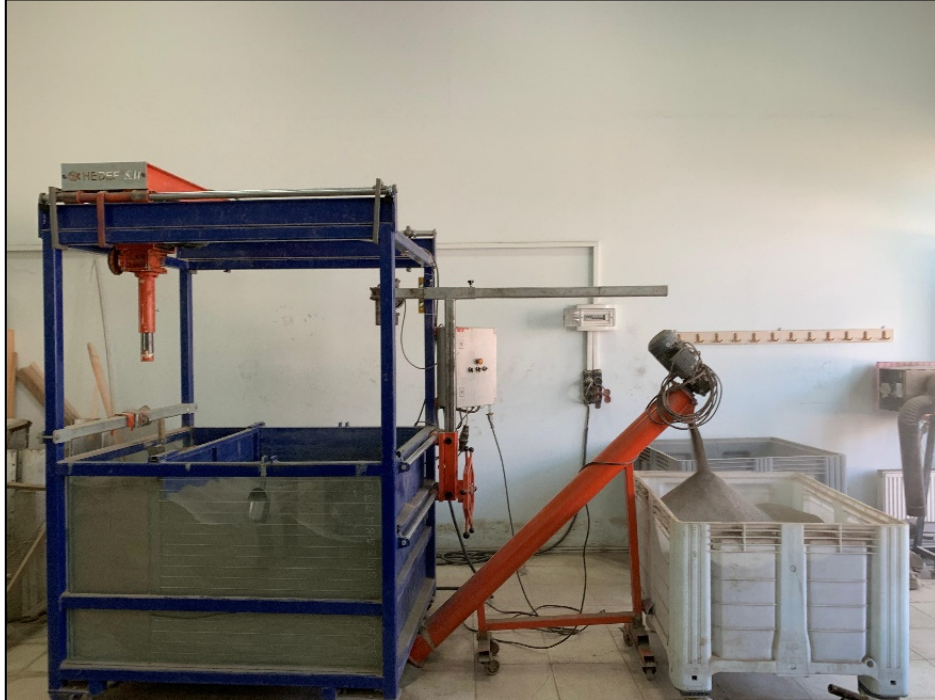
Şekil 1. Kum havuzu ve helezonik sistem
