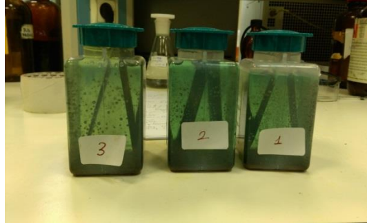
Şekil 10. Polistiren Numunelerin Elektrolizsiz Bakır Çözeltisi İçerisine Daldırılması
