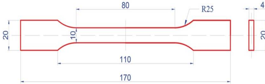
Şekil 3. Çekme test numune ölçüleri
