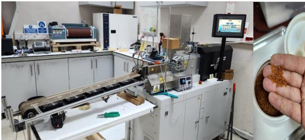
Şekil 2. Çift vidalı ekstrüder cihazı ve PP+KÇKT katkı granül
