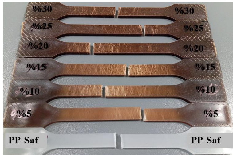
Şekil 10. Çekme numunesi test sonrası
