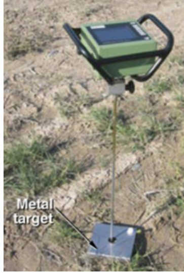
Şekil 22. Penetrometre cihazı ile toprak sertliğinin ölçülmesi
