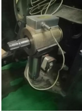
Şekil 24. Torkmetre-traktör bağlantısı görünümü
