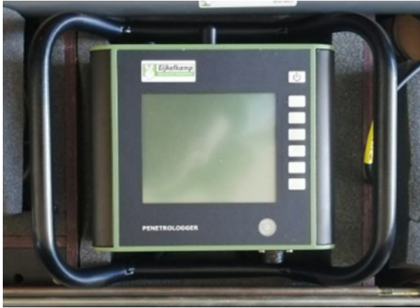
Şekil 11. Toprak sertliğinin ölçülmesi için kullanılan penetrometre cihazı
