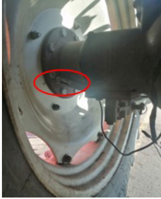
Şekil 25. Manyetik etkili sensörün konumu
