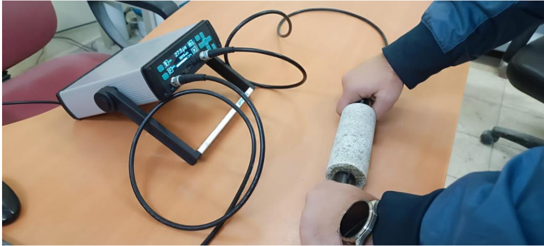
Şekil 4. Ultrasonik dalga boyu hızının ölçülmesi
