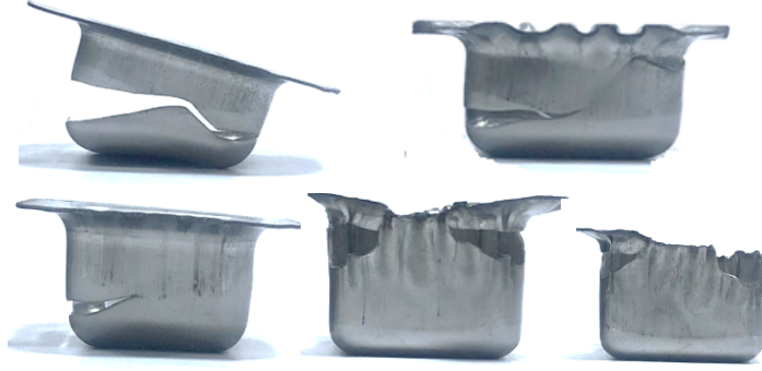
Şekil 7. Deneyel çalışmalar sonucunda oluşan çeşitli deformasyonlar ve hatalar.
