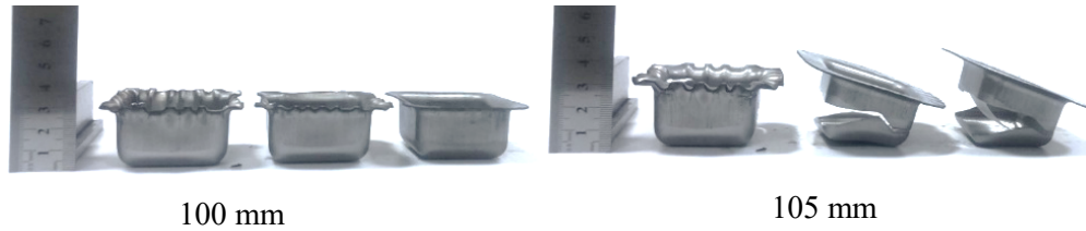
Şekil 6. 100 mm ve 105 mm ilkel parça çapında BPK'nın değişimi ile oluşan deformasyonlar.
