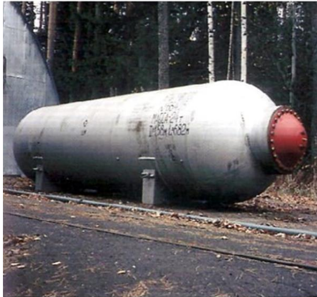
Resim 3. Harrell vd., arşivi, nükleer madde içeren küçük patlamaları tutmak için kullanılan “Kolba” (Harrell ve Hoffman, 2013, s. 27).
