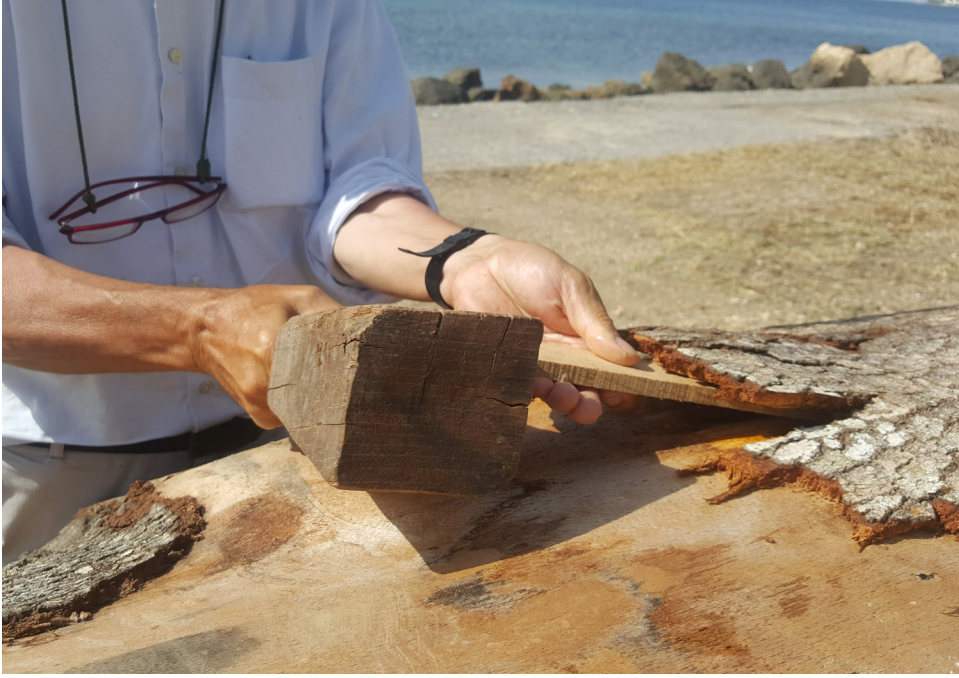
Fig. 5. Tomruğun üzerindeki kabuğun soyulması çalışmalarının görüntüsü
