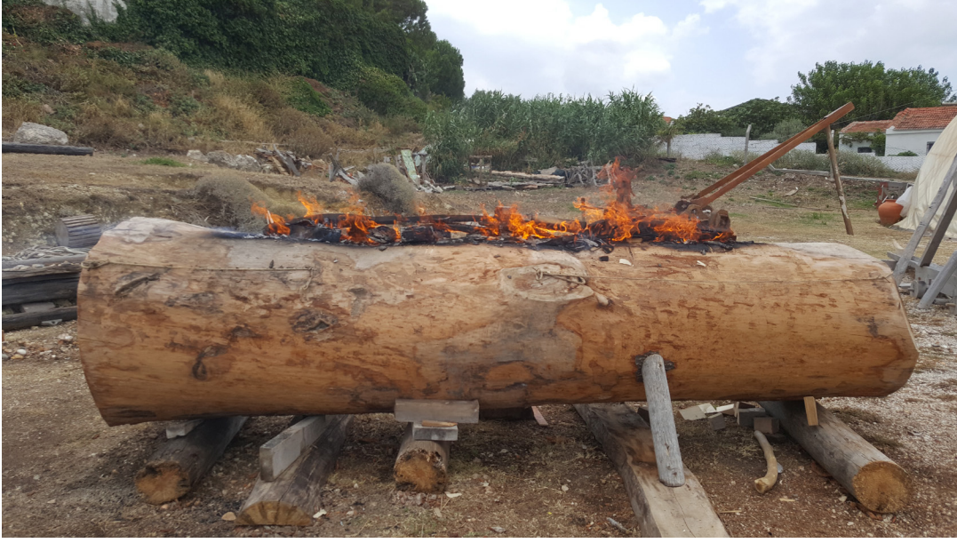
Fig. 9. Kontrollü ateş tekniği
