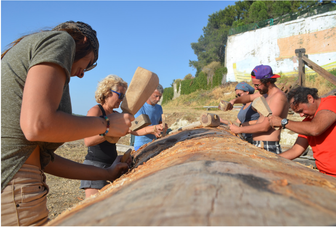
Fig. 6. Tomruğun üzerindeki kabuğun soyulması çalışmalarının görüntüsü
