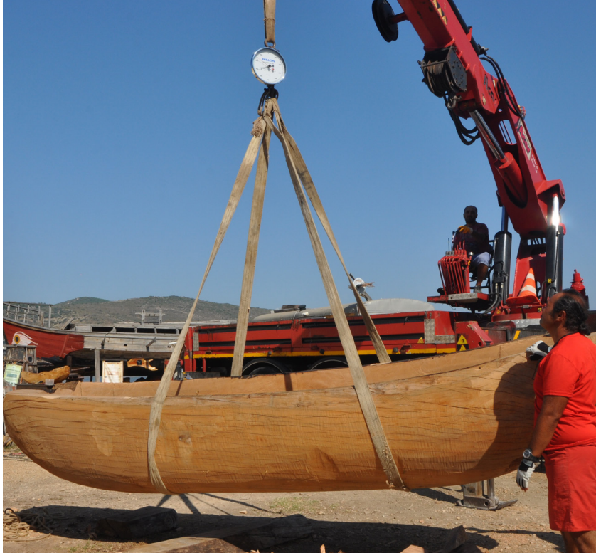
Fig. 14. Kanonun vinç yardımı ile tartılması
