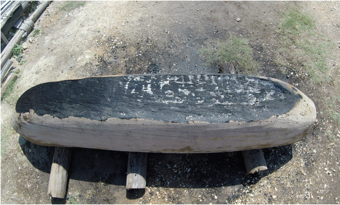
Fig. 18. Kanonun alt kısmının düzleştirilmesi
