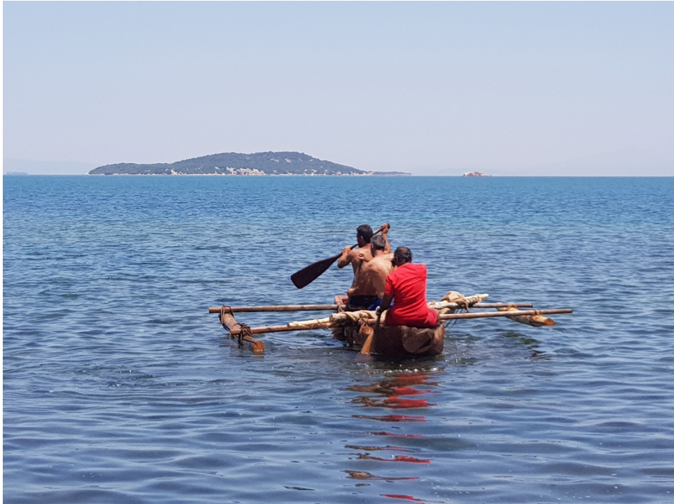
Fig. 16. Çift denge kolu ile performans denemeleri
