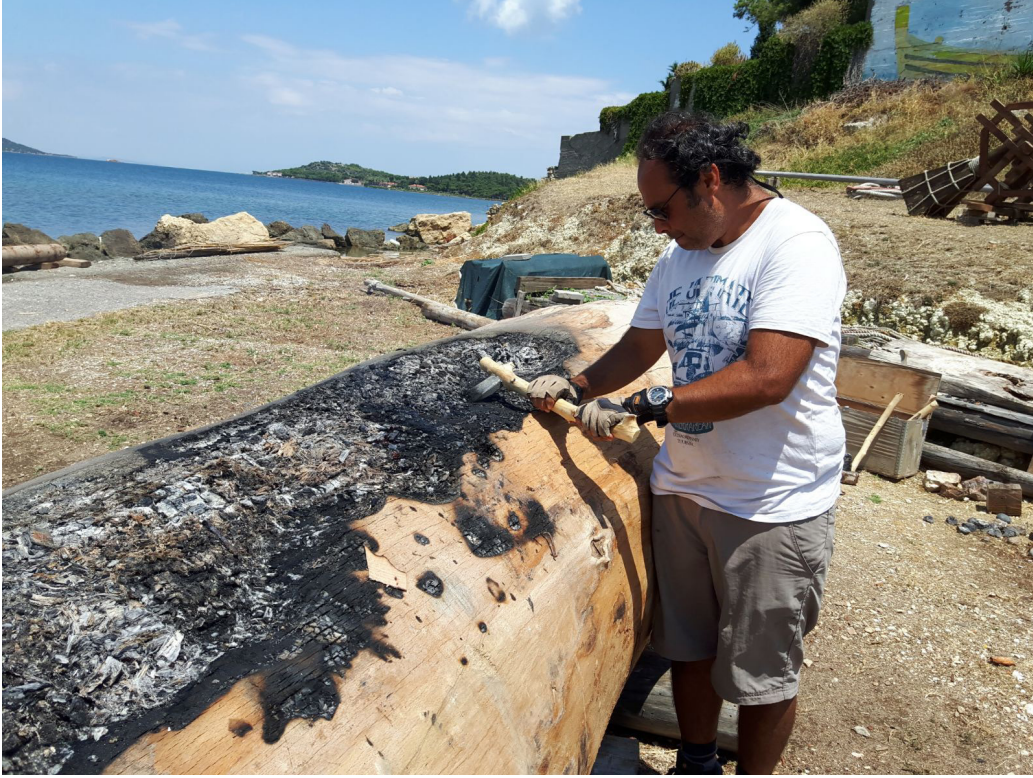
Fig. 10. Yakarak oyma kazıma işlemi görüntüsü
