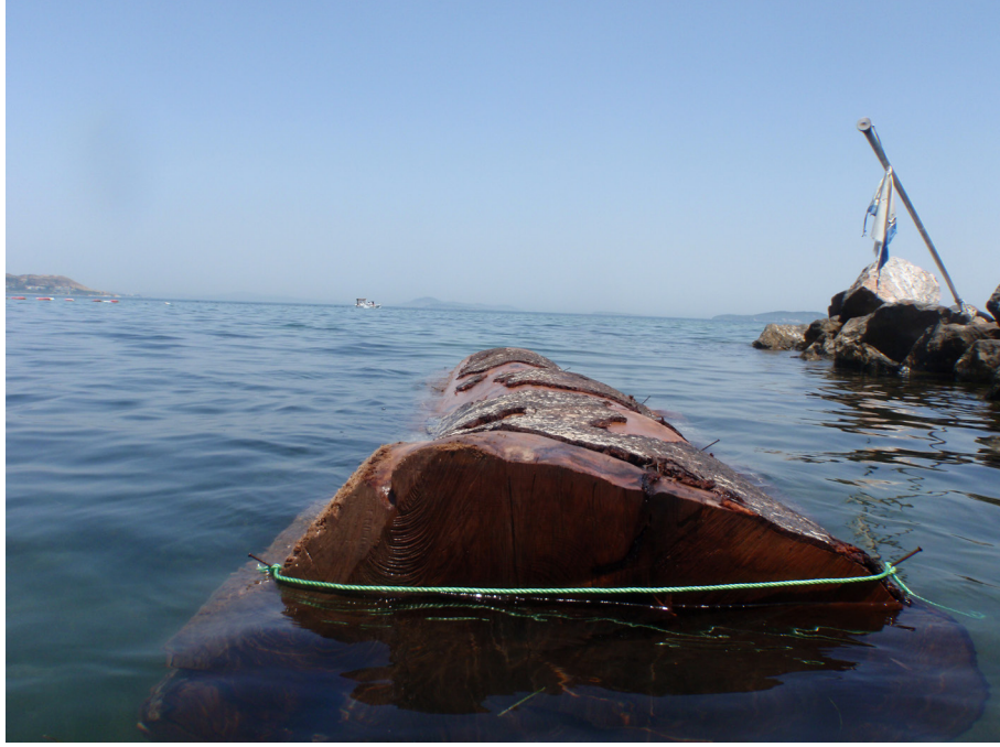
Fig. 3. Tomruğun ağırlık merkezinin ve su hattının belirlenmesi görüntüsü
