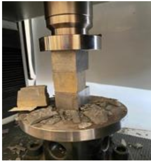
Şekil 2. Tek eksenli basma deneyi
