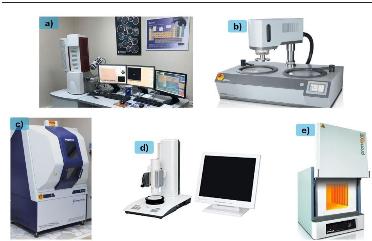
Şekil 1. Deneyler çalışmalarda kullanılan test cihazları; (a) SEM, (b) zımparalama ve parlatma, (c) XRD, (d) stereo mikroskop, (e) yüksek sıcaklık fırını
