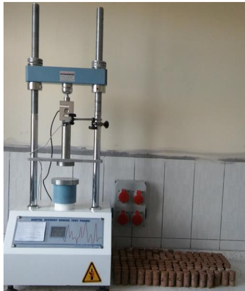
Şekil 6: Tek eksenli basınç dayanım cihazı ve numuneler
