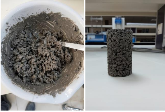
Şekil 1. Karışım hamuru ve geçirimli kazık görselleri
