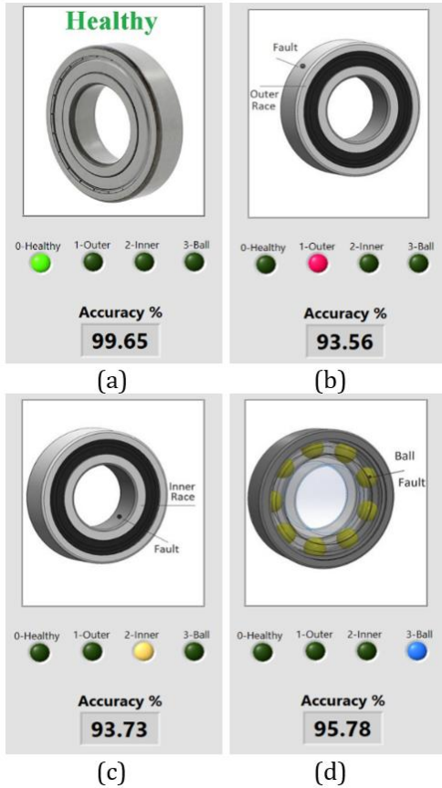
Şekil 12. GUI-3 Test Sonuçları a) Sağlam Rulman b) Dış Bilezik Arızası c) İç Bilezik Arızası d) Bilye Arızası
