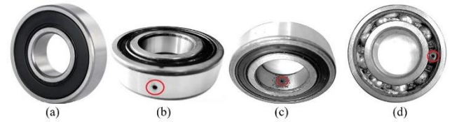
Şekil 2. Çalışmada kullanılan rulmanlar a) sağlam, b) dış bilezik arızalı, c) iç bilezik arızalı, d) bilye arızalı
