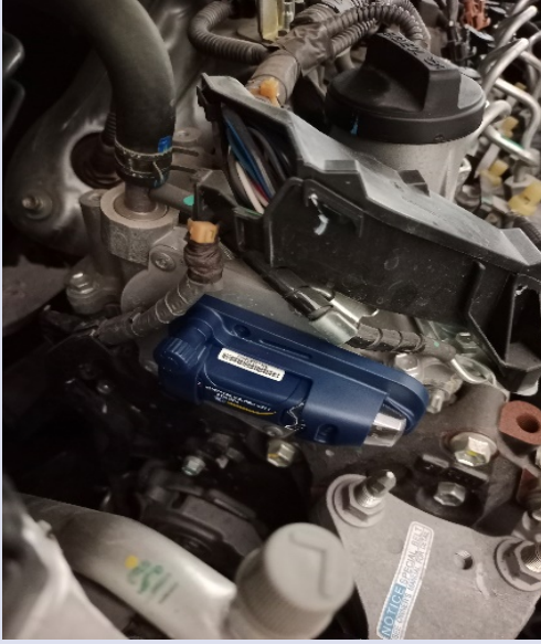
Şekil 3. Titreşim ölçerin motor üzerindeki yerleşimi Figure 3. Location of the vibration meter on the engine
