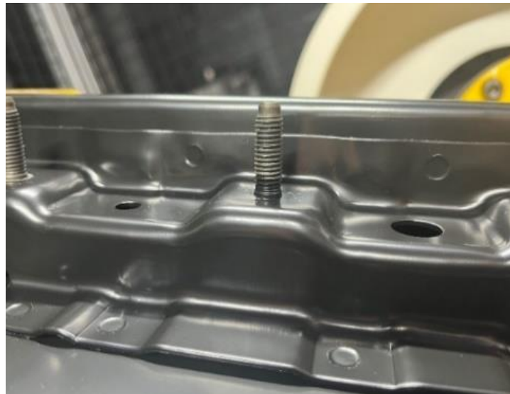
Şekil 5. Cıvatanın taban bölgesinde boya birikimi.
