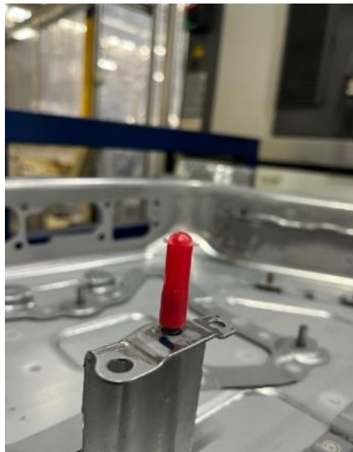
Şekil 4. Yanlış maskelenmiş cıvata örneği.
