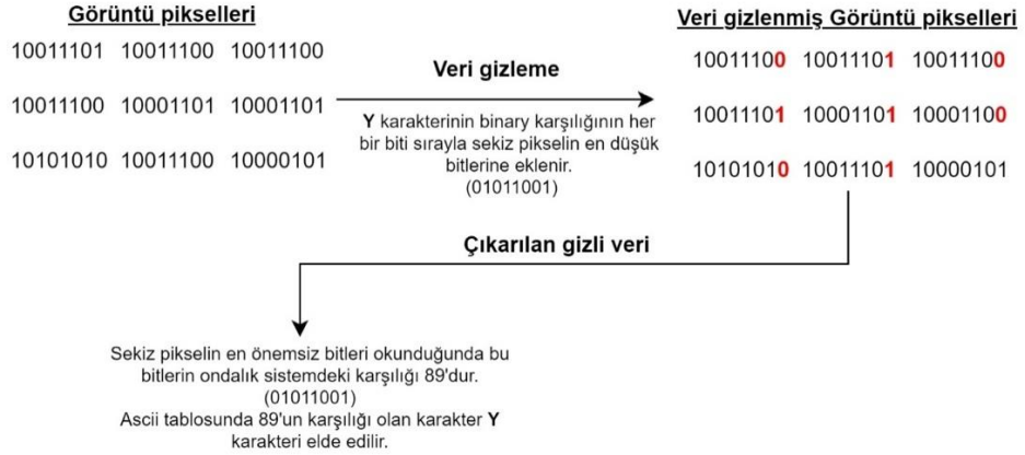
Şekil 1. Görüntü Piksellerine Metin Verisinin Eklenmesi ve Çıkarılması
