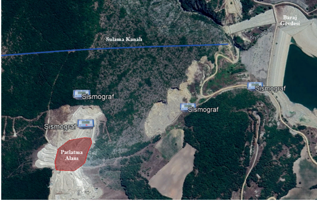
Şekil 4. Patlatma yapılan bölge, risk unsuru olarak belirlenen baraj gövdesi, sulama kanalı ve sismografların konumlarını gösteren uydu görüntüsü
