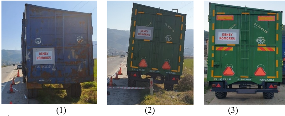
Şekil 1. (1) İkazsız (ikaz işaretleri olmayan) römork, (2) TSE normlarına uygun işaretli römork, (3) TSE normlarına ek işaretli römork.
