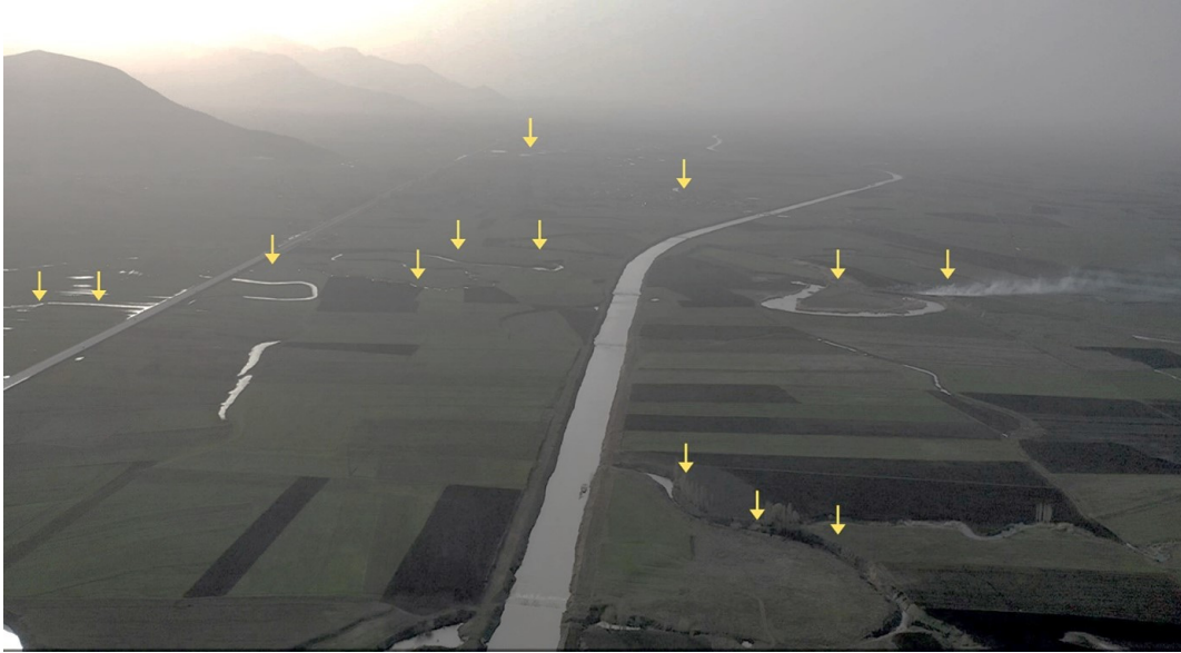
Foto 1. Karasu Nehri yatağında kopuk menderesler (Muş Ovası, Muş Havalimanı güneyi, 2022). Görselde ok işaretleri, ıslah müdahaleleri sonrasında akarsu kanalından ayrılan eski menderes izlerini göstermektedir. Bu tür kopuk menderesler, kanalın yapay olarak stabilize edilmesinin ardından flüvyal sistemin doğal evrim kapasitesinin sınırlandırıldığının somut göstergeleridir.
