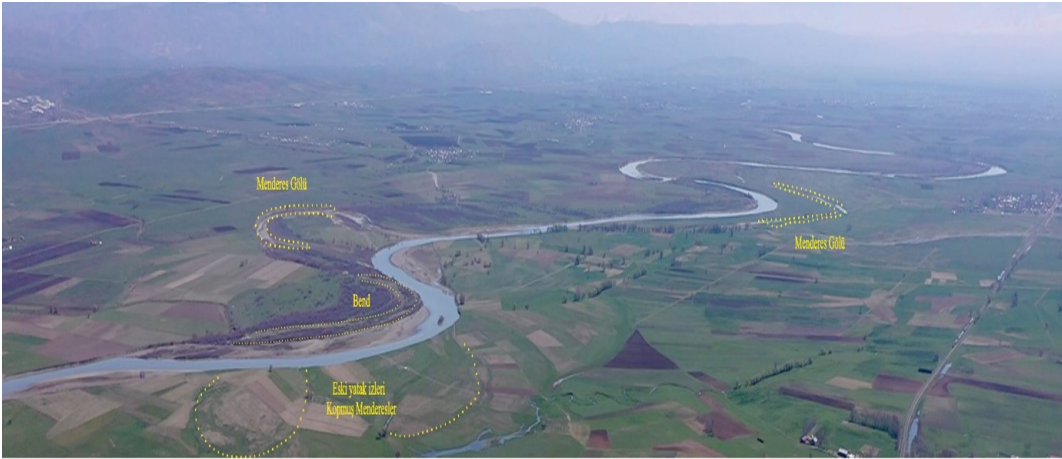
Foto 2. Murat nehrinin batı kolu üzerinde gözlenen yatak değişim izleri (Muş Ovasının güneybatısı, 2023). Fotoğrafta, menderes göçü ve yanal erozyon süreçlerinin oluşturduğu eski kanal izleri açıkça seçilmektedir. Bu tür izler, nehir yatağının kısa dönemli morfolodinamik tepkilerini ve kanal stabilitesindeki değişimleri göstermesi bakımından önemlidir.
