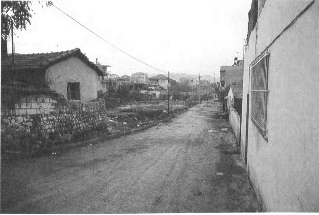
Foto: 19- Kasım 1995 . Dallık deresi üzerinde yer alan Ve “Çukur Mahalle” olarak bilinen yerleşim alanı. Doğu-Batı yönünde uzanan ve orta kesimi kenarlara göre daha çukur olan bu kesim, gerçekte Dallık deresinin doğal mecrasıdır. Bu nedenle normal yağışlarda bile birçok evi su basmaktadır.
